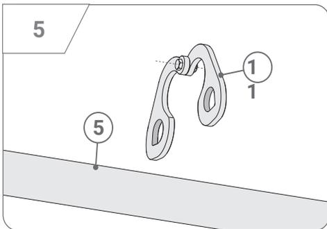
Ein Stück Gummi zwischen die Klemme und das Stangenrohr legen, um zu verhindern, dass die Klemme auf der Stange verrutscht.
