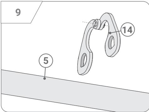
Ein Stück Gummi zwischen die Klemme und das Stangenrohr legen, um zu verhindern, dass die Klemme auf der Stange verrutscht.
