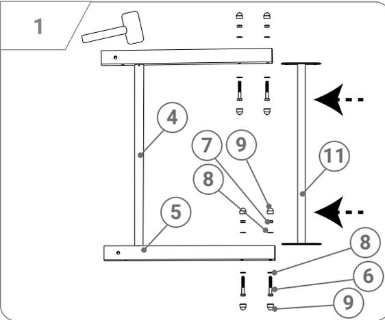
Si vous avez des difficultés à ajuster le tube dans l'ouverture, pliez le tube de 1 mm à l'aide d'un marteau.
