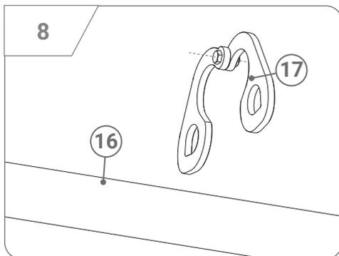
Placer un morceau de caoutchouc entre la pince et le tube de la barre pour éviter que la pince ne glisse sur la barre.
