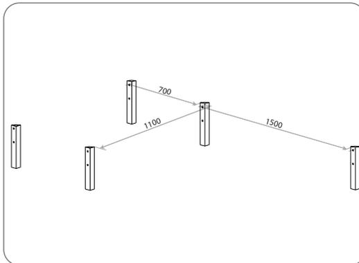
Dopo aver montato la parte in superficie dell'attrezzo, misura la distanza tra i profili verticali, o appoggia il telaio a terra e fai delle buche profonde almeno 60 cm.
